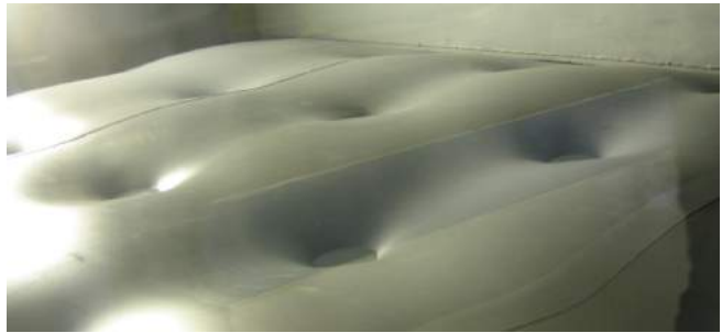
Prova di tenuta delle piastre su un manto sintetico in una camera di prova, simulando l'azione del vento.
